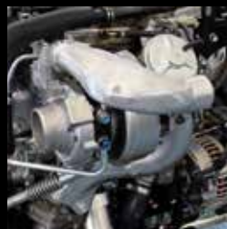
Turbopunjač promjenjive geometrije (VNT)
